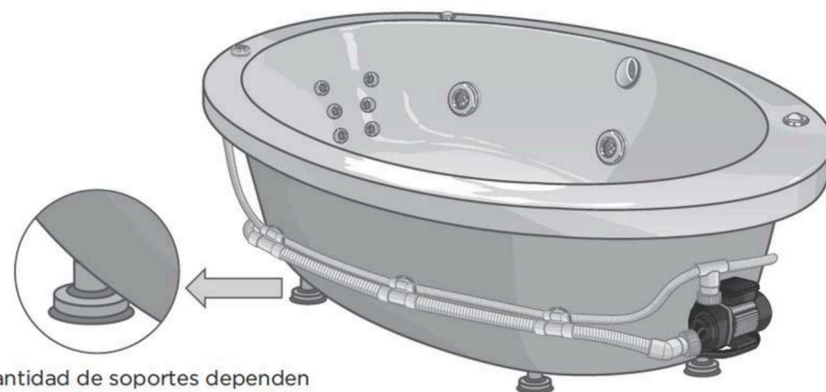
La cantidad de soportes dependen del diseño de la tina y la superficie en donde se va a instalar.
