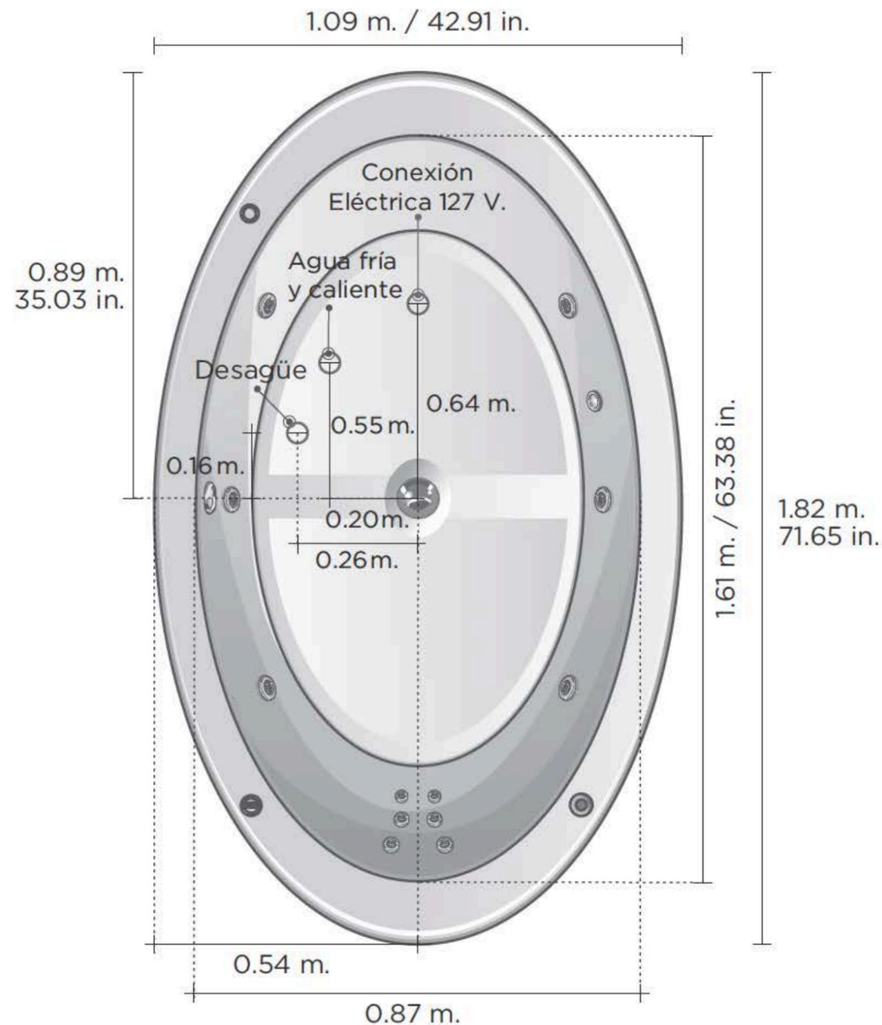
Será necesario proporcionar tres elementos importantes y al alcance del área del equipo para el funcionamiento de la tina.
