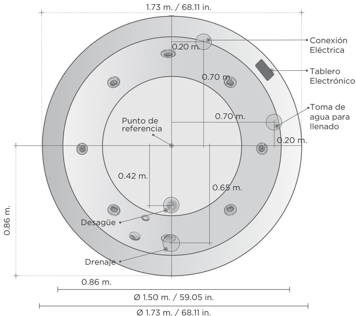
Será necesario proporcionar tres elementos importantes y al alcance del área del equipo para el funcionamiento de la tina.
