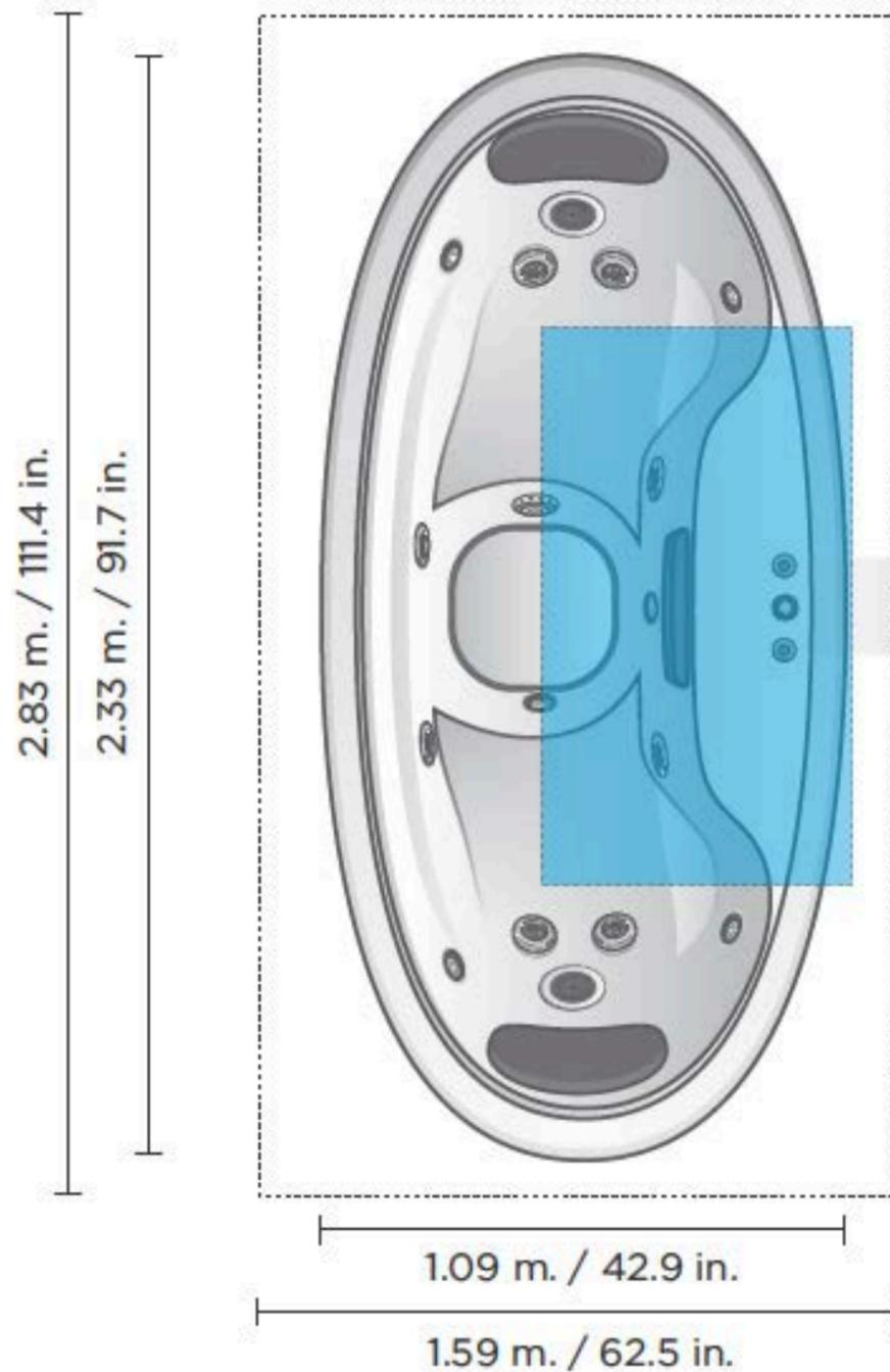
Se debe garantizar un **espacio libre en la zona técnica (marcada en azul)** para facilitar el acceso al sistema hidráulico, motobombas y conexiones.
