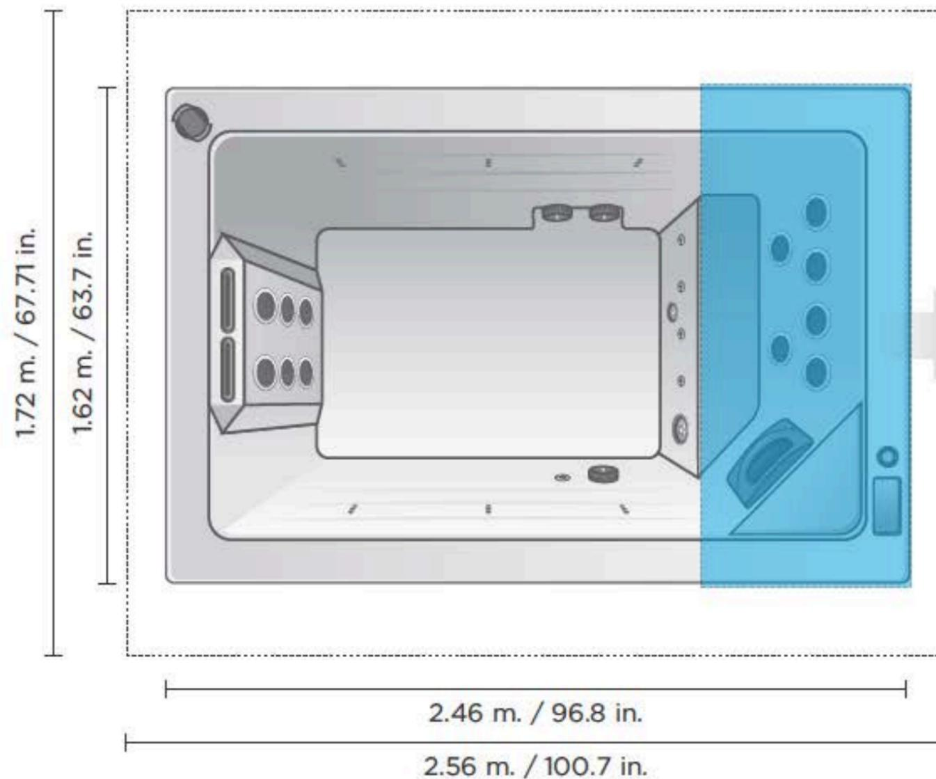
Se debe garantizar un **espacio libre en la zona técnica (marcada en azul)** para facilitar el acceso al sistema hidráulico, motobombas y conexiones.
