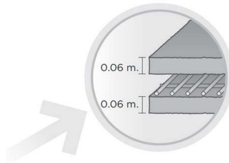
La ilustración muestra la forma en la que debe armarse el firme. Es **necesario colocar dos capas de colado de un espesor de 0.06 m. una arriba de otra, reforzada en su interior** de un tramado metálico.
