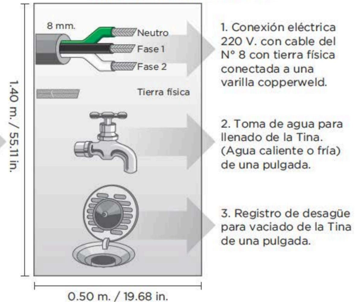
Es necesario **colocar un firme** sobre el cual se **instalará el Spa** y que dará **soporte suficiente para el peso** que se genera por el llenado de la tina y el empleo por los usuarios recomendado.
